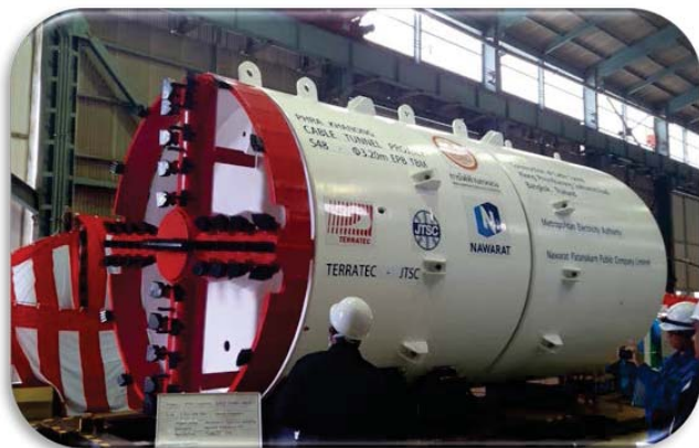
หัวเจาะ TBM
